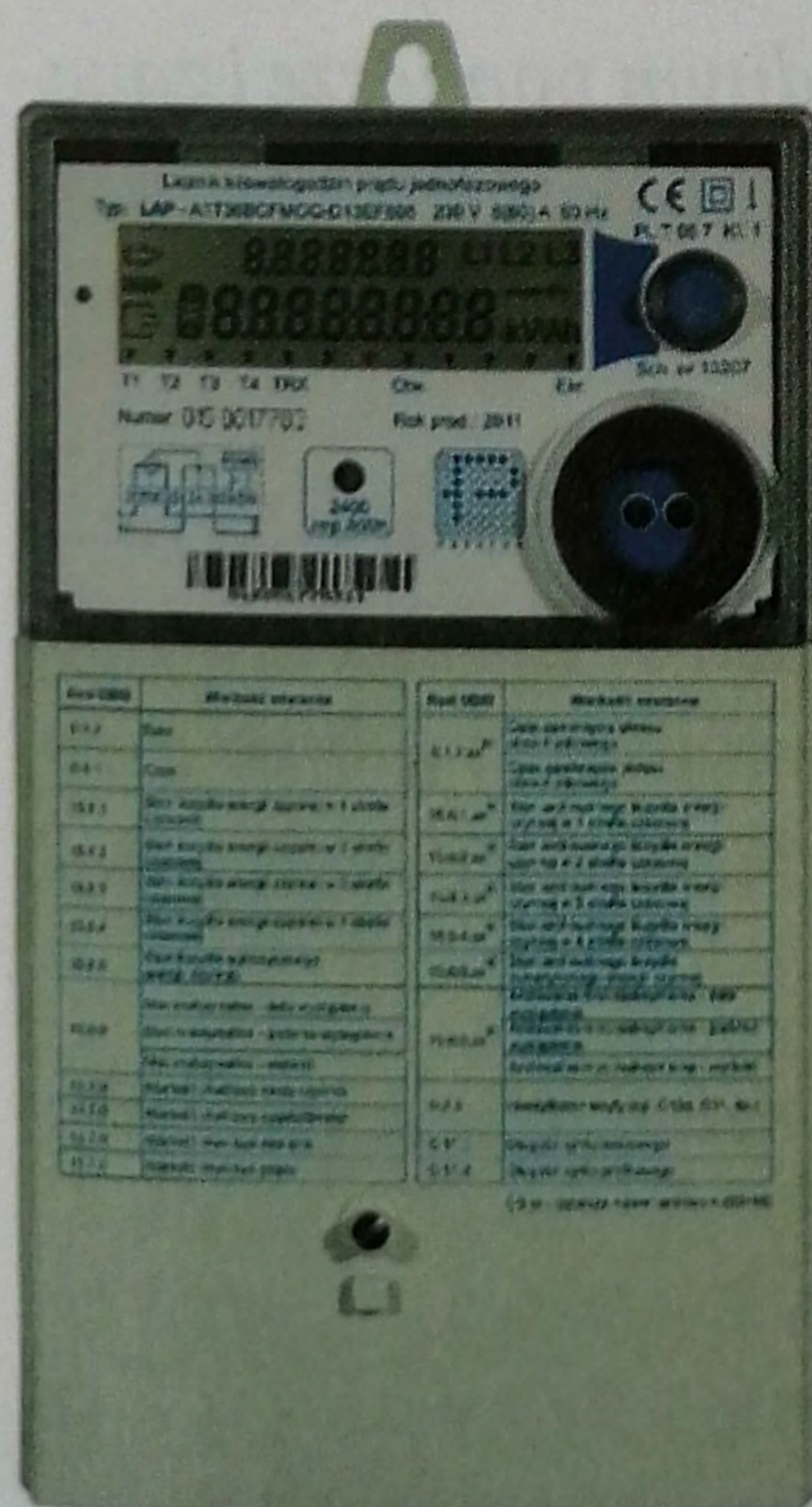
Rys. 2.55 Przykład licznika energii elektrycznej elektronicznego jednofazowego a – wygląd zewnętrzny, b – schemat podłączenia
